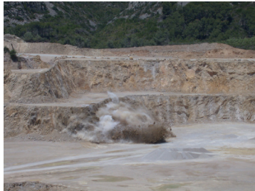
Uso de explosivos (voladuras).
