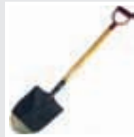
Pala con terminación en punta para favorecer la inserción en el material
