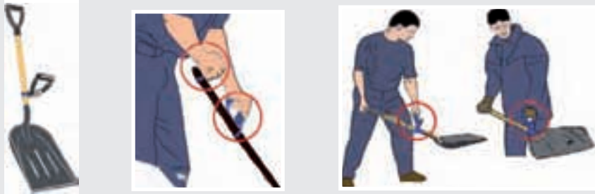
Posturas de trabajo en palas con asideros adicionales
