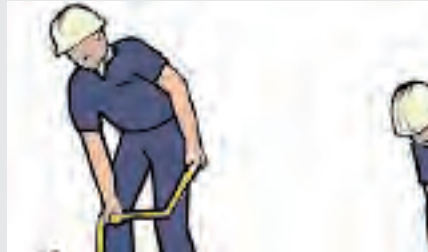
Mejora de la postura de trabajo con una pala de mango angulado
