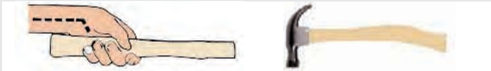
Nuevo diseño del mango para mejorar la postura de la muñeca
