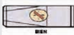
Unión adecuada de la cabeza el martillo
