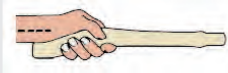
Diseño curvado del mango para mejorar la postura de la muñeca
