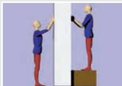
Mejora de la postura de trabajo al instalar una plataforma
