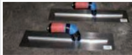
Recubrimiento del mango para evitar presiones intensas en la mano
