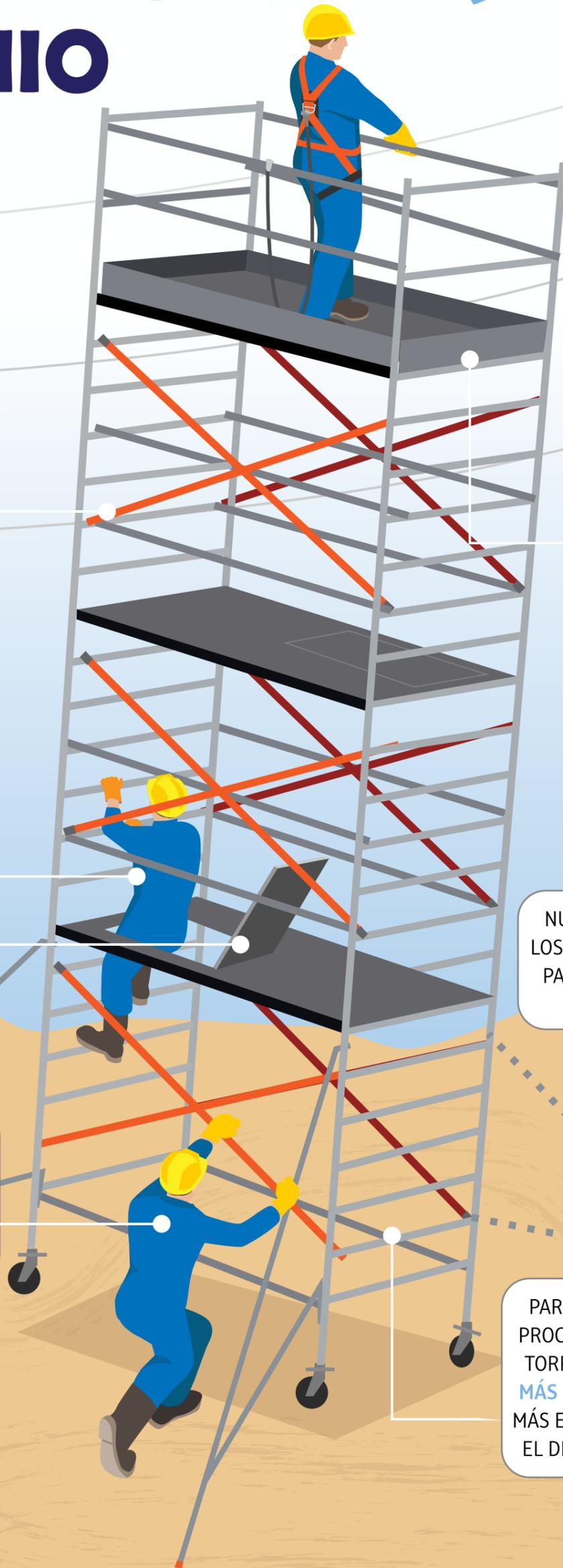
MONTA Y UTILIZA EL EQUIPO CONFORME A LAS INSTRUCCIONES DEL FABRICANTE. **NO OLVIDES LAS DIAGONALES**
